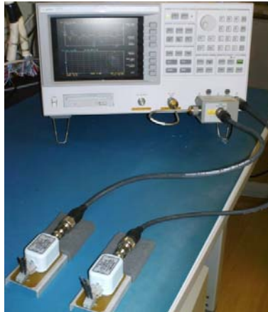
Figura A.2: Setup de medição para função de transferência H e parâmetro de espalhamento S_{11} , sendo que para esse último apenas um balun é utilizado deixando a porta de saída em aberto.
