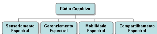
Fig. 1. Módulos de um sistema de rádio cognitivo.
