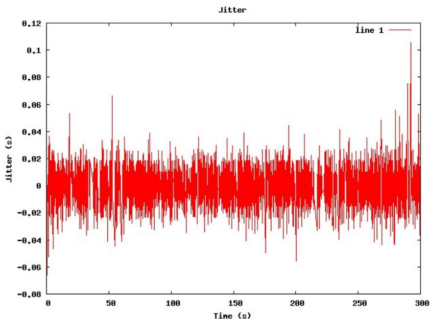
Figura 7 – Comportamento do *jitter* VoIP 8 Mbps.
