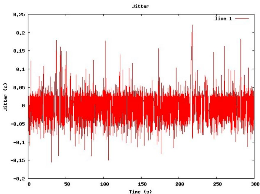
Figura 6 – Comportamento do *jitter* VoIP 1 Mbps.
