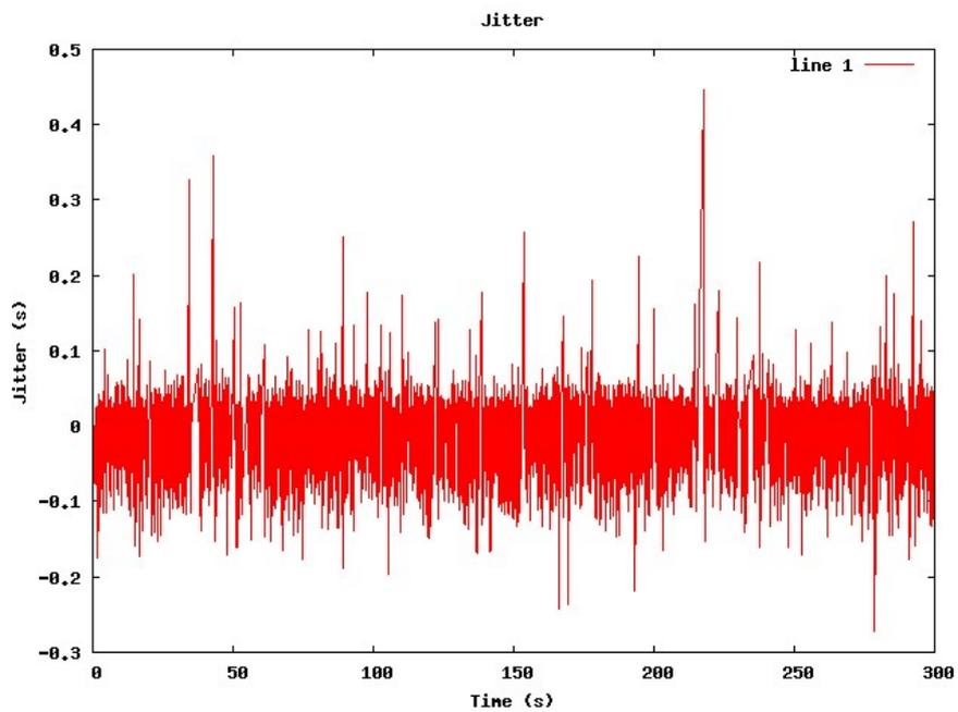
Figura 5 – Comportamento do *jitter* VoIP 600 kbps.
