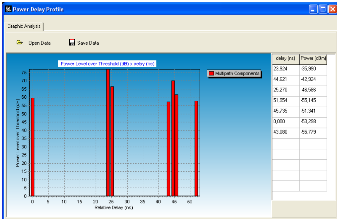
Figura 4.35 – Perfil de Retardos de Potência ( Power Delay Profile ) para o ponto L5
