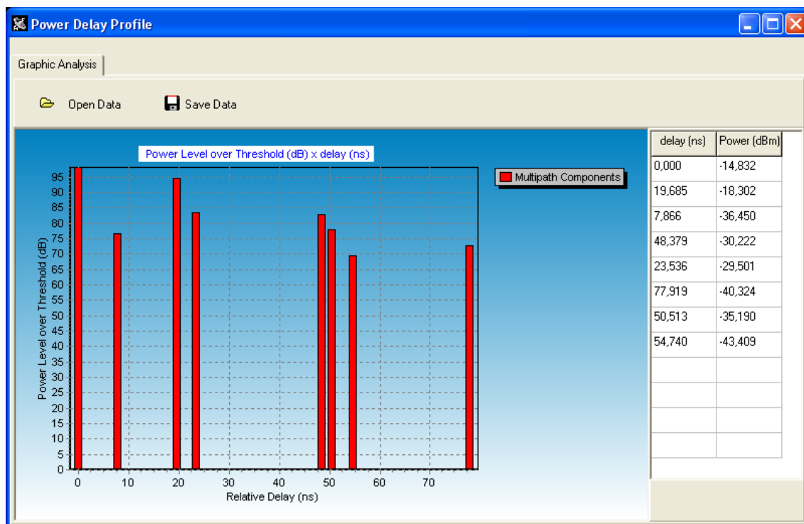
Figura 4.27 – Perfil de Retardos de Potência ( Power Delay Profile ) para o ponto L1
