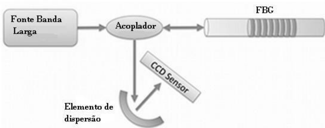
Figura 2.6: Esquema para interrogador com sensor CCD.
