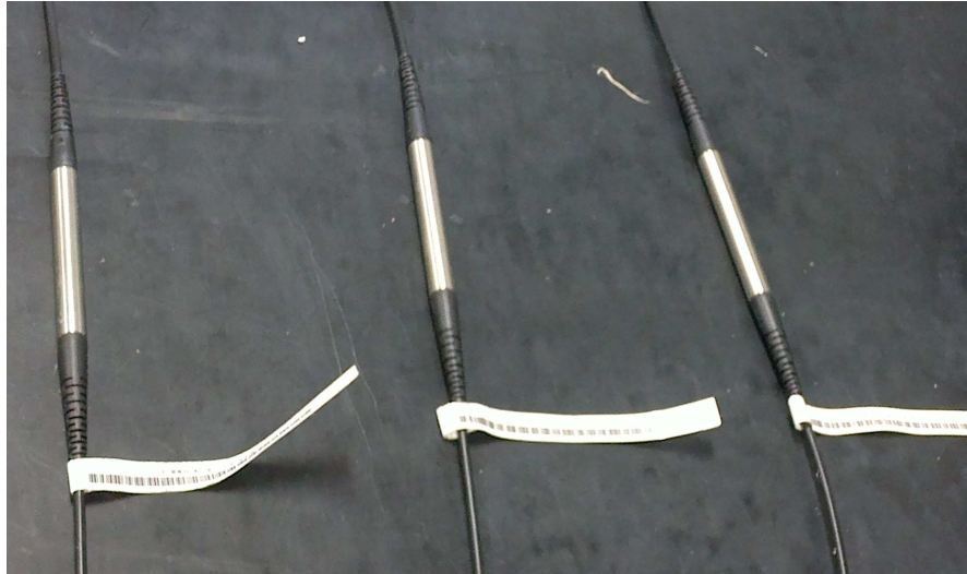
FIGURA 4.9: Sensores de temperatura FS6300 utilizados no Experimento 2.
