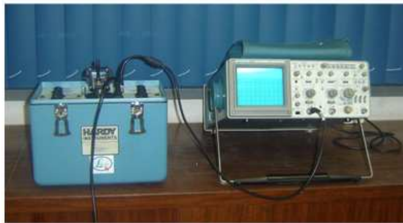
Figura 4.2: Esquema de ligação nó sensor, shaker e osciloscópio.
