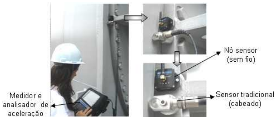
Figura 4.7: Esquema de medição utilizando o medidor e analisador de aceleração
