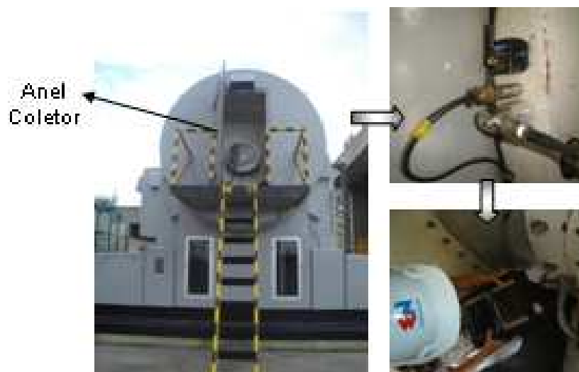
Figura 4.13: Posicionamento dos sensores internos ao compensador.
