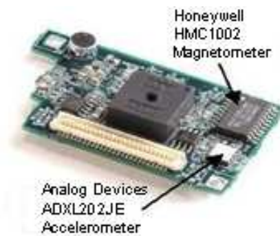
Figura 4.1: Placa de sensores MTS-310
