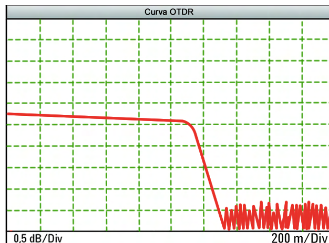
Figura 3.13: Curva OTDR para uma quebra na fibra ou enlace aberto.
