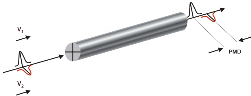
Figura 3.9: Dispersão por Modo de Polarização na fibra.
