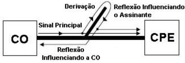
Figura 2.6: Efeito de uma derivação nos sinais
