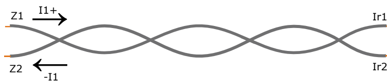
Figura 9 – Conversão de modo diferencial para o modo comum caso Z1 \neq Z2 e I_c \neq 0 .
