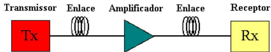
Figura 4.4: Posicionamento do amplificador de linha em um enlace óptico
