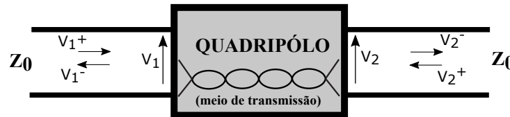
Figura 8 – Parâmetros de espalhamento caracterizando um canal de transmissão por meio das porções de tensão V_1 e V_2
