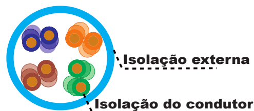
Figura 17 – Cabo Cat 5e montado no CST com os parâmetros medidos.
