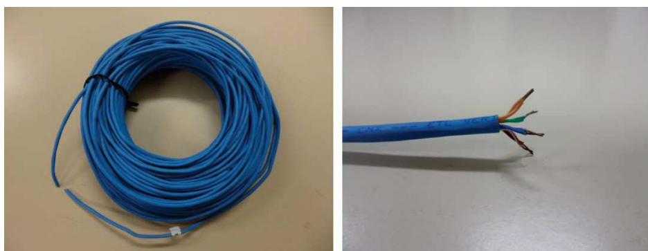
Figura 16 – Um cabo CAT 5e real presente no laboratório. À esquerda um cabo CAT 5e enrolado, e à direita, a ponta deste cabo, evidenciando os pares trançados.
