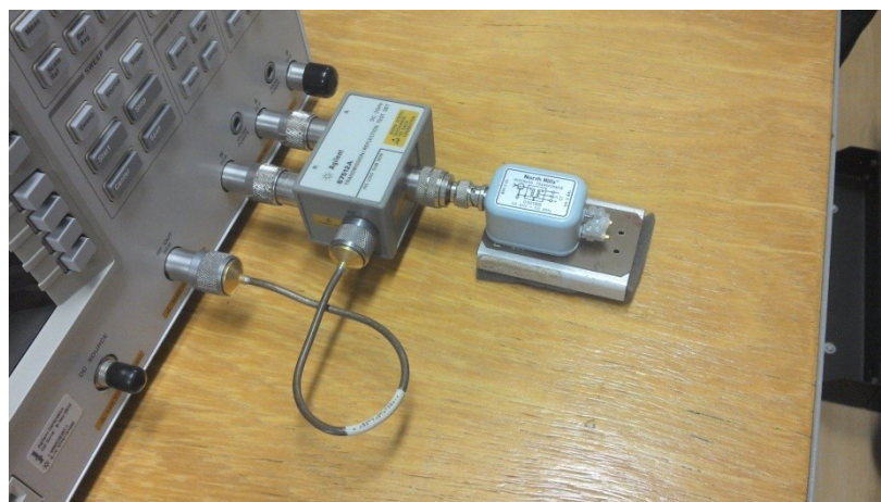
Figura 5. As três peças conectadas ao equipamento. A esponja na base do balun ajuda a dar um nivelamento mais adequado.
