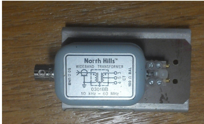
Figura 3. Balun conversor de banda-larga. A conversão será de 50 para 100 Ohms e a faixa usada é de 10Khz-60Mhz.
